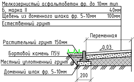
КОНСТРУКЦИЯ ПОКРЫТИЯ ОТМОСТКИ ТИП 3а
