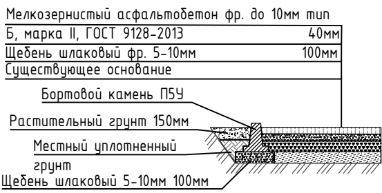
КОНСТРУКЦИЯ ПОКРЫТИЯ СУЩЕСТВУЮЩИХ ПЛОЩАДОК У ПОДЪЕЗДОВ И ТРОТУАРОВ ТИП 3
