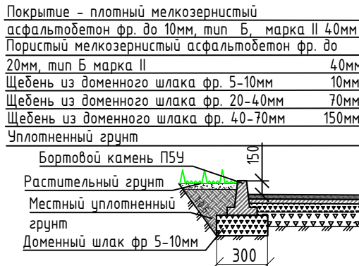
КОНСТРУКЦИЯ ДОРОЖНОЙ ОДЕЖДЫ УСТРОЙСТВА ПАРКОВОК И РАСШИРЕНИЕ ПРОЕЗДА ТИП 1
